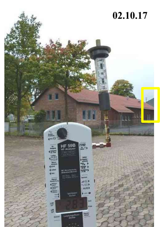
Sende- Parkplatz Stadtgärtnerei, Eiche (von S) Trompetenbaum, Messwert: 13.580 \mu\text{W}/\text{m}^2 anlage Stadtgärtnerei. Montagehöhe: 15,8- 18,1 m; 15 Sektorantennen: 5 x 60°, 5 x 180°, 5 x 300° Im Botanischen Garten zeigten die Buche und zahlreiche weitere Bäume deutliche Schäden.
